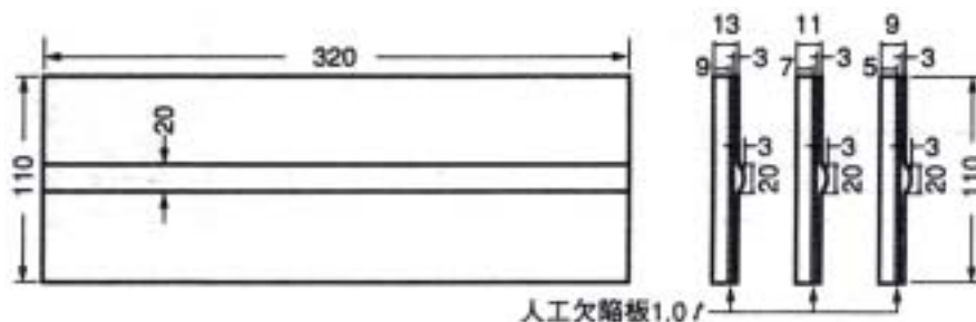
図 1 レベル 1 用アルミニウム平板試験体 (板厚：9.0mm、11.0mm、13.0mm)
