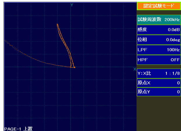
図5 上置コイル試験時の画面
