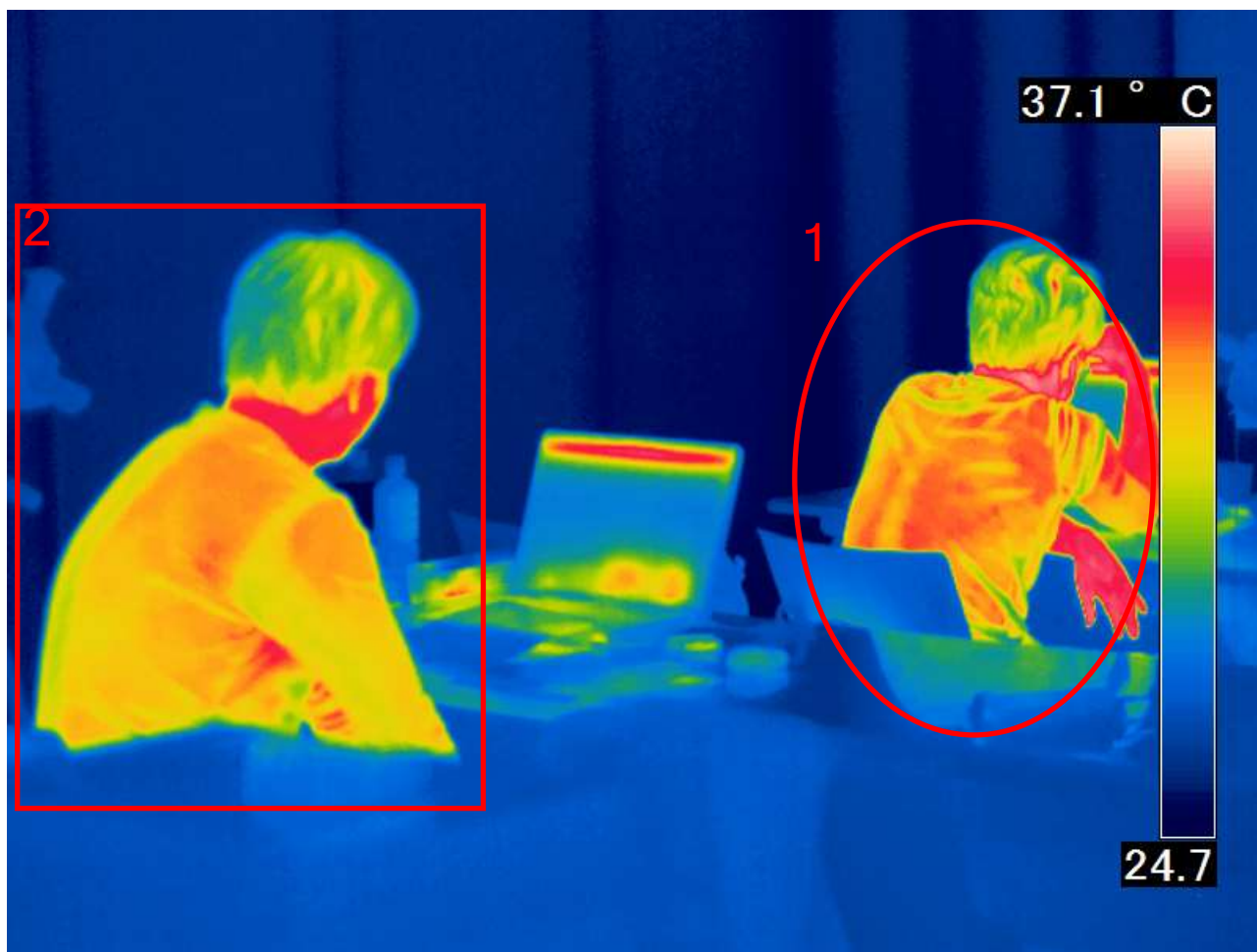
図の説明：熱画像（レベルを調整した良い例）
